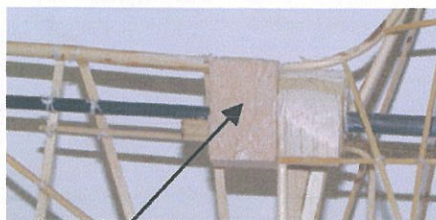
翼を胴に差込バルサ材を接着すること。
